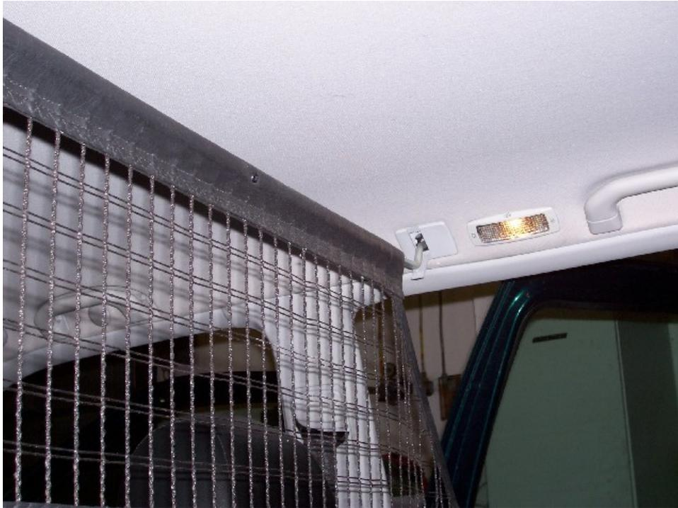
Und je nach gewünschtem Einbauort (hinter den vorderen oder hinteren Sitzen) entweder in den nachgerüsteten Blechlaschen am vorderen Ende der Rücksitzbank oder an den serienmäßigen Zurrpunkten im Kofferraum vorn befestigen. Einhängen, dann mit den Spanngurten des Gepäcktrennetzes festzurren.
