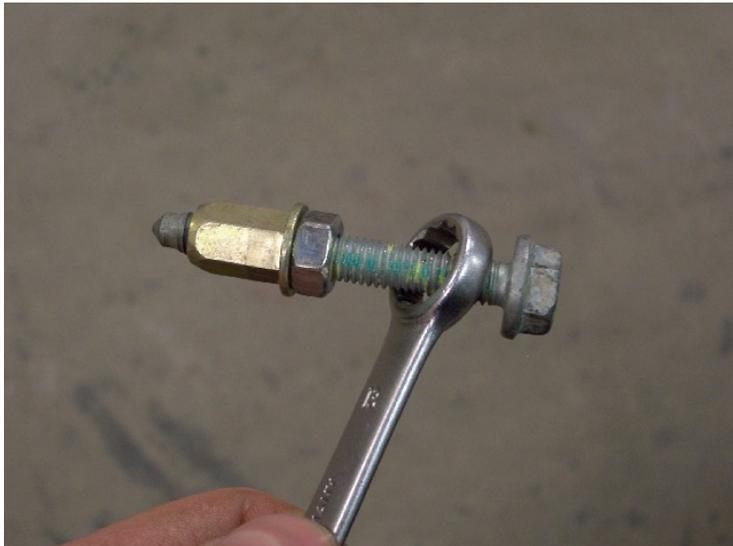
Setzt den Gewindeniet flach an das Blech an, nicht verkannten! Haltet nun die Schraube fest und dreht gleichzeitig die Mutter in Richtung Gewindeniet. Dadurch wird der Gewindeniet in das Blech eingezogen.
